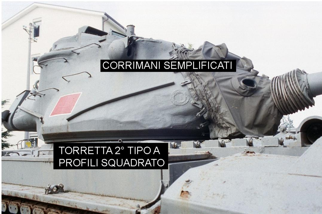
N.B.: la foto precedente rappresenta un carro musealizzato sul quale il telo del cannone è stato sostituito con quello di un M60A1.
