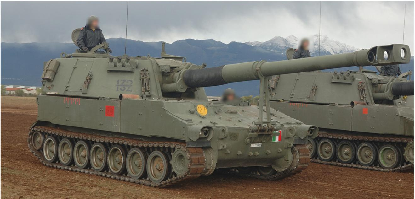
Posizionare i tre settori di tiro forniti ai lati e dietro la torretta. Il simbolo stilizzato del reparto fa posizionato al posto degli STANAG (area scura visibile a lato del maniglione di sollevamento e sul parafango posteriore sinistro)
